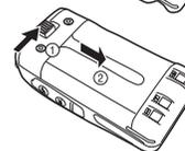
Для снятия аккумулятора отодвиньте защелку и сдвиньте аккумулятор с радиостанции.
