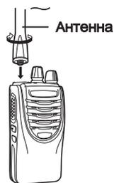
Навинтите антенну на разъем сверху радиостанции, удерживая антенну за основание и вращая ее по часовой стрелке до отказа.
