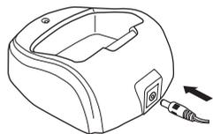
Подключите провод сетевого адаптера в разъем, находящийся сзади зарядного устройства.
