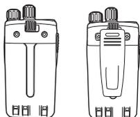
При необходимости присоедините поясную клипсу. Для снятия клипсы нажмите на пружинный зажим 1 на ней и потяните клипсу вверх из гнезда 2.
